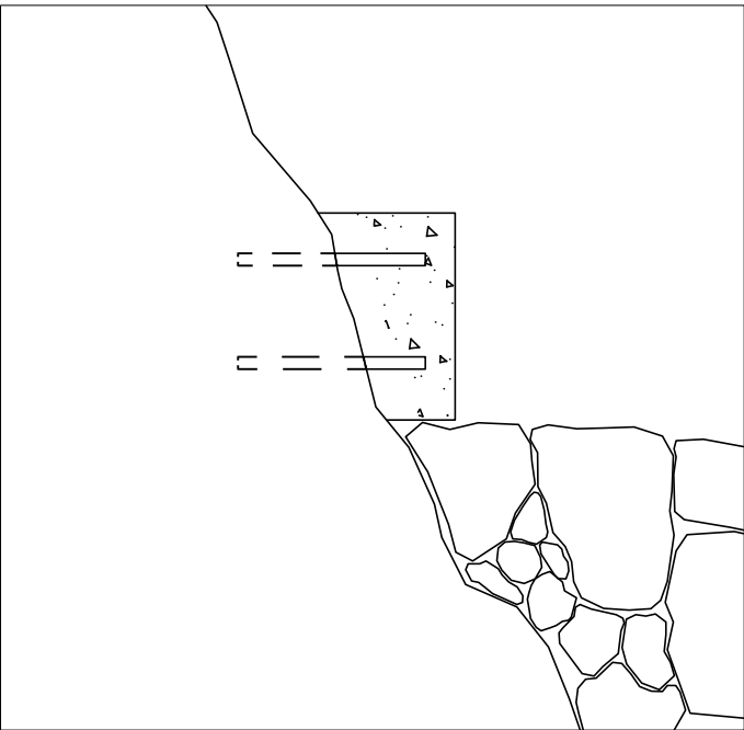
Sikring av eksisterende mur
